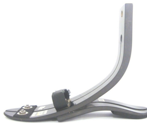
تصویر ۲: پنجه پروتزی فلکس فوت مورد آزمایش
